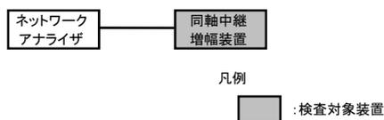
図 1-1-9 利得可変範囲、帯域内偏差、利得安定度及び VHF 帯域通過率検査における装置構成（参考）
